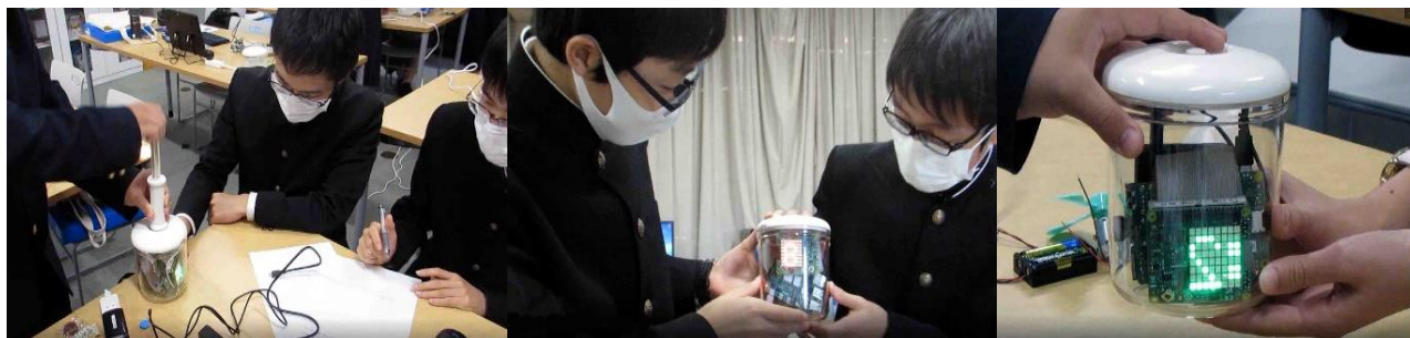
〈図4〉 人工衛星では各種センサーを使って装置の動作を調整(制御)。ポンプで空気を抜く台所雑貨の真空保存容器の中にセンサーを入れて測定するようす
