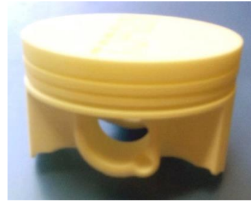
<3DPrinter で作ったエンジンのピストン部分>
