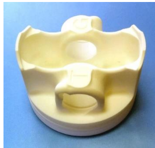
<3DPrinter で作ったエンジンのピストン部分>
