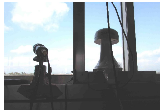
＜高高度発光現象スプライトの観測のために校舎4階廊下に設置した CCD カメラ等 ＞
