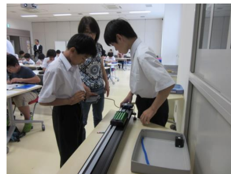
(写真1) モーションエンコーダシステムを利用して測定中
